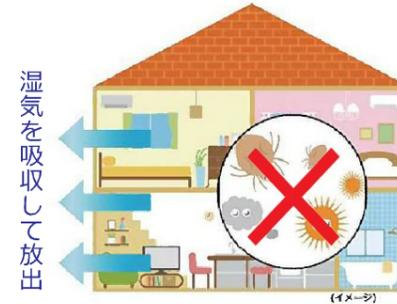
微細な連続気泡セルが湿気を吸収して放出。内部結露の発生を抑え、カビやダニの繁殖、木材の腐食から住まいを守ります。壁が水分を含んで垂れ下がる心配もありません。
