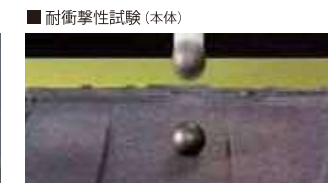
JIS A 5423準拠した鋼球を落下させる耐衝撃試験でも割れやクラックは認められませんでした。
