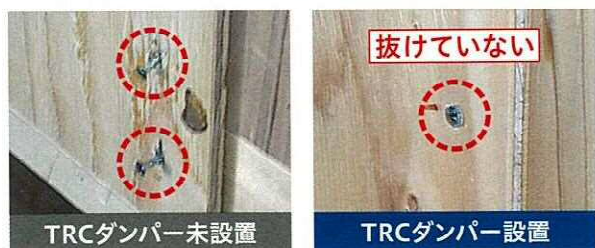
繰り返し地震3回目での釘抜けの様子
